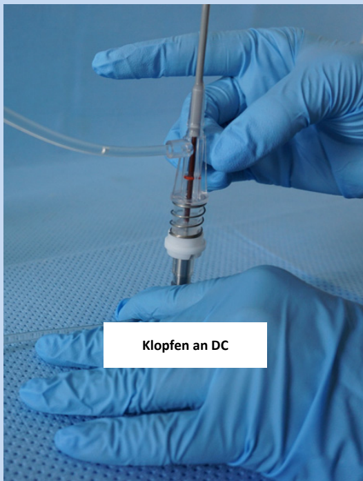
Abbildung 48: Sammeln der Luft in Drive Coupling.
