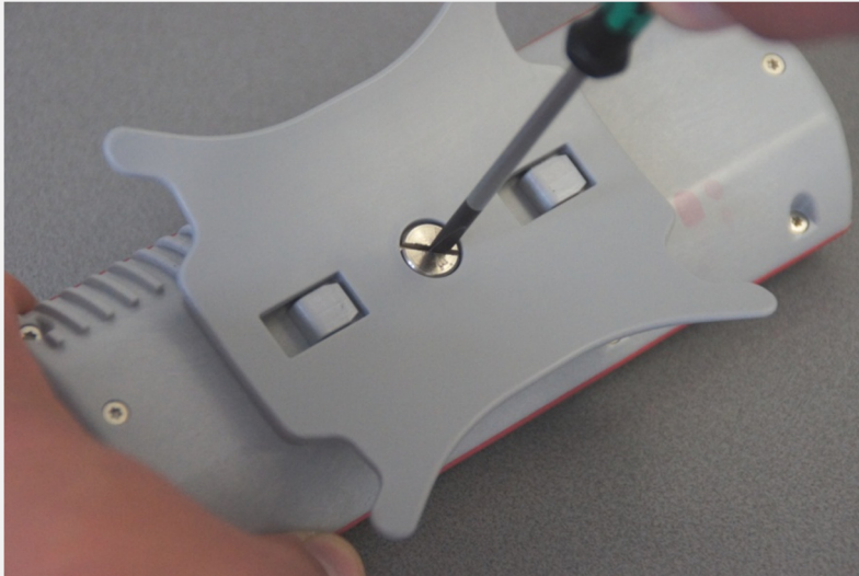
Abbildung 86: Lösen der Schraube an der Unterseite der Drive Unit
