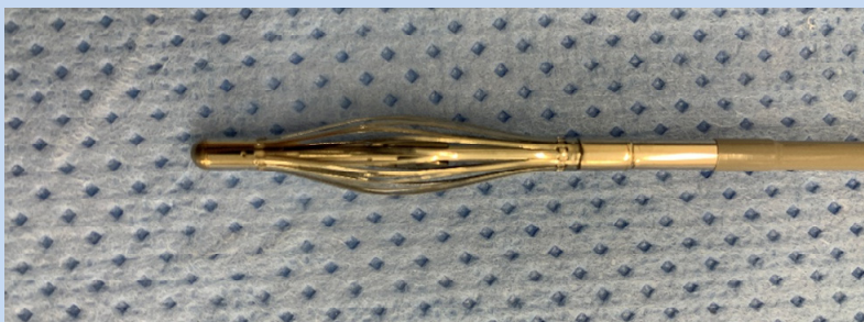
Abbildung 61: Vollständig geschlossener Pumpenkopf.
