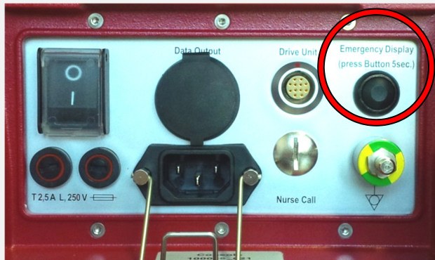
Abbildung 82: Knopf zur Aktivierung der Notbetrieb-Einheit
