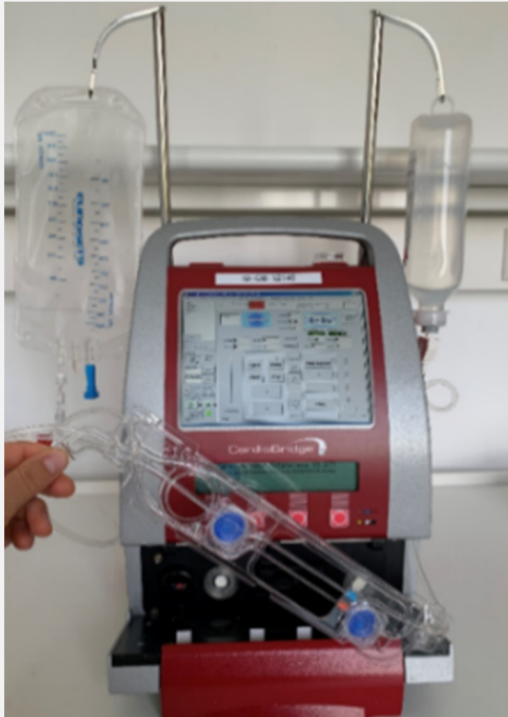
Abbildung 36: Entlüften des Druckdomes durch Unterdruck und Neigen der Kassette.
