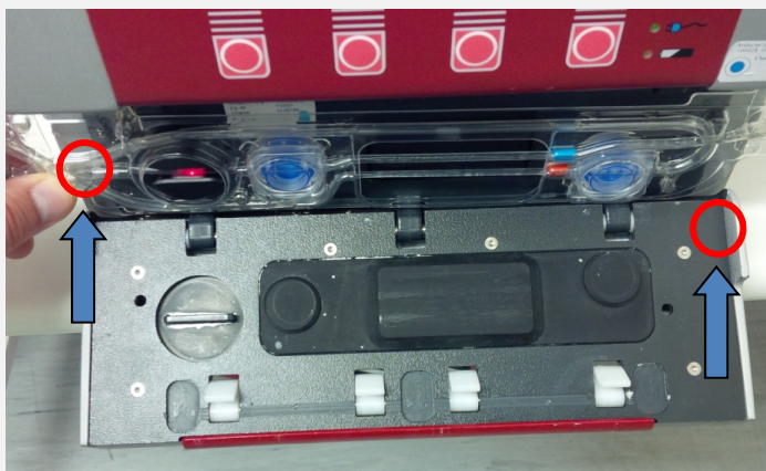
Abbildung 37: Einlegen der Kassette in das Kassettenfach.
